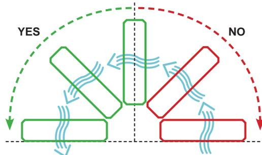
Le chauffage ne doit pas être monté flux d'air orienté vers le haut
